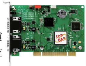
**PEX-730A 隔离型数位输出板卡**
