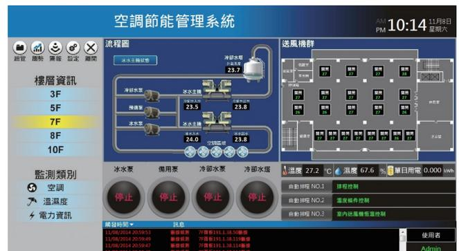
测冰水主机的入水跟回水温度，适时调整温度值；统一管控末端送风温度，以减少冰水主机运转能耗；记录冰水主机运行周期，调整制冰时间，避开尖峰用电时段等，这些方式都能够达到不同程度的能源管理。
