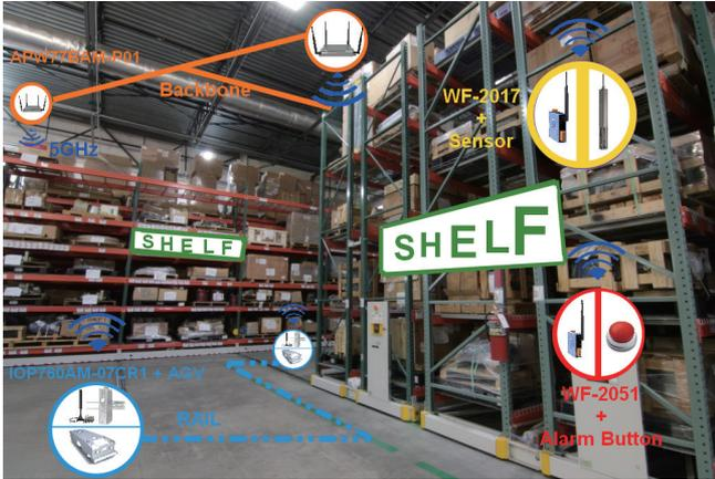
能使用 APW77BAM-P01 与 IOP760AM-07CR1 来实现无人搬运车仓储系统, 最主要是 APW77BAM-P01 内建快速漫游 (Fast Roaming) 的功能, 让使无人搬运车 (AGV) 在两个基地台移动时不会中断通讯, 即使无人搬运车要做长距离的移动, 只要 APW77BAM-P01 扩展延伸到的 Wi-Fi 环境, 就可以随心所欲的通讯而不中断。
